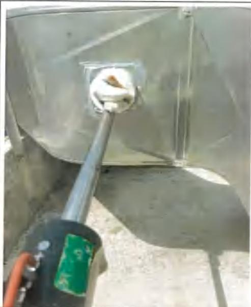
图 9.7 厨房油烟废气处理前检测口 ©Q5
